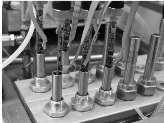
Abb 3: Laboraufbau des Differenzdruck Feuchtgenerators
